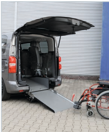
Bei ausgeklappter Rampe lässt sich das Fahrzeug bequem mit dem Rollstuhl befahren.
